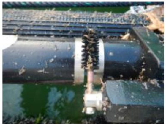
図3. 設置7日後の水中紫外線硝酸塩センサの汚損状況
