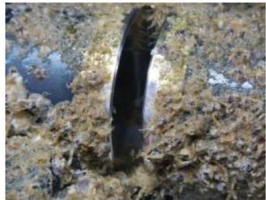
図 6. 回収時（設置 17 日後）の水中紫外線硝酸塩センサの汚損状況（その 3）
