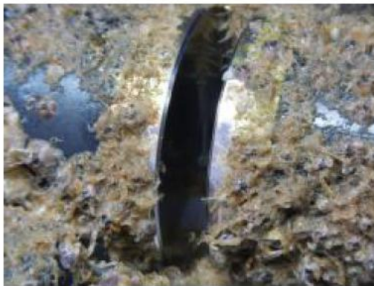
図 6. 回収時（設置 17 日後）の水中紫外線硝酸塩センサの汚損状況（その 3）
