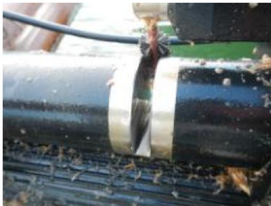
図3. 設置7日後の水中紫外線硝酸塩センサの汚損状況
