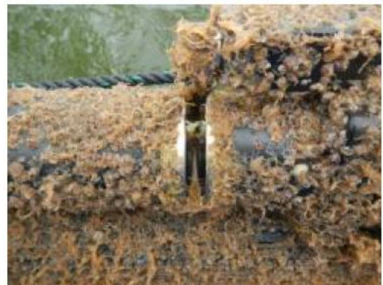
図6. 回収時（設置17日後）の水中紫外線硝酸塩センサの汚損状況（その2）
